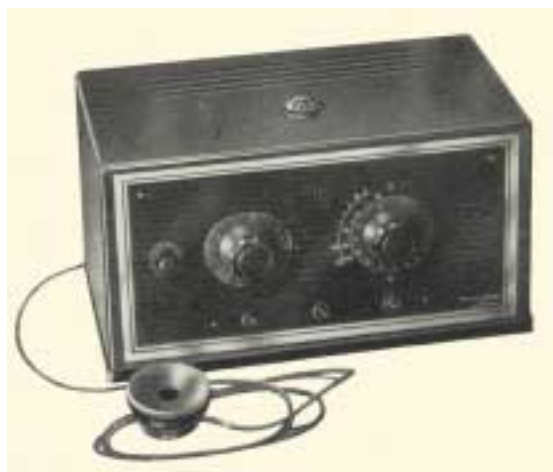
Figuur 5. Western Electric 6A. De eerste in ons land gebruikte audiometer (jaren 30).
