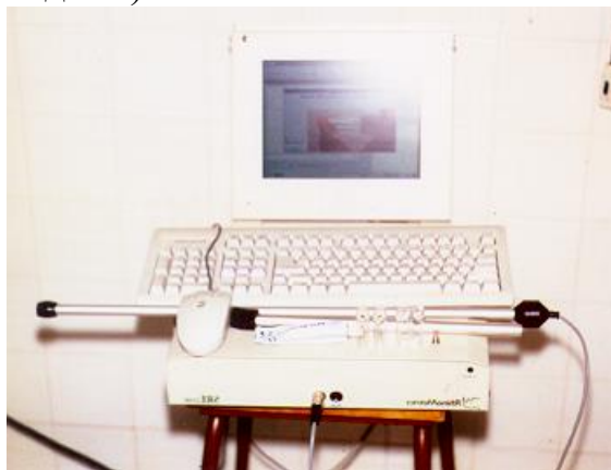
Фиг. 22. Общ вид на акустичният ринометър SRE 2100 (Rhinometrics, Denmark) с различните размери носни накрайници и сондата за възрастни.
