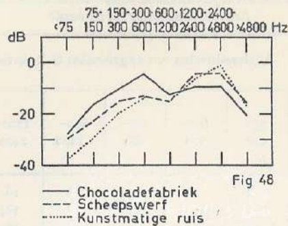
FIGUUR 48 - De spectra van het lawaai, gebruikt bij het onderzoek van de tijdelijke gehoordrempelveranderingen door kortdurende inwerking van fabriekslawaai [intensiteitsverschillen in dB per octaaf ten opzichte van het totale niveau].
