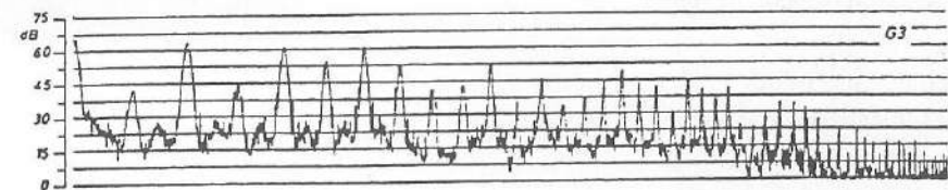
Figuur 3.11. Klankspectrum van een viool (Meyer 1978).
