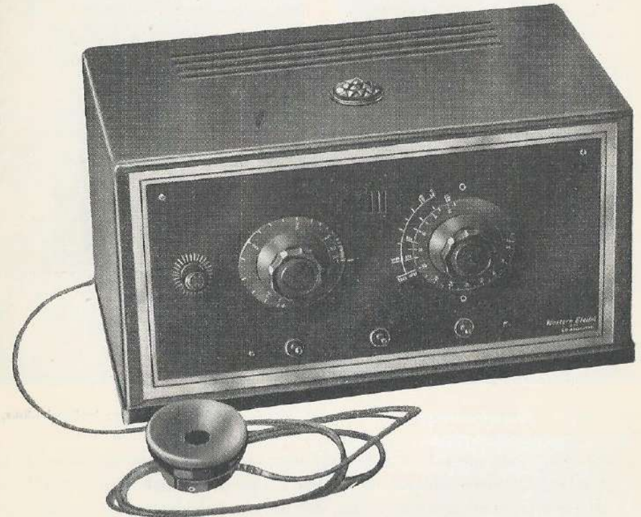
Fig. 6. Western Electric 6-A Audiometer met electrodynischen weer-gever voor luchtgeleidingsmetingen.
