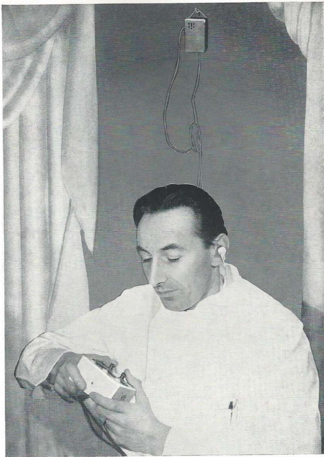
Eén der proefpersonen, opgesteld in de geluidsarme kamer. Het gebruikte hoorapparaat is vrij opgehangen in een rustige hoek, achter een gordijn, dat op de foto is weggeschoven.
